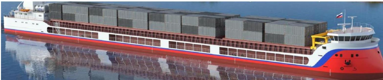
**Основные технические характеристики:** длина судна - 141 м, ширина - 16,9 м, высота борта - 6,3 м. Объем грузовых трюмов - 12 тыс. куб. м, дедвейт в море – 9200 т (при осадке 5,3 м), в реке 5000 т (при осадке 3,6 м), скорость – 10 узлов
